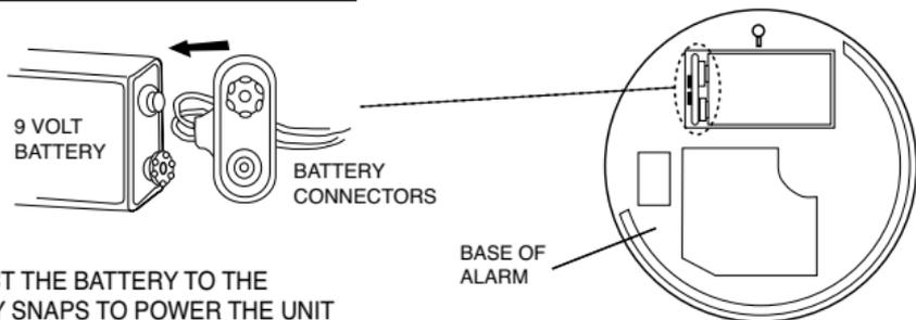
CONNECT THE BATTERY TO THE BATTERY SNAPS TO POWER THE UNIT
